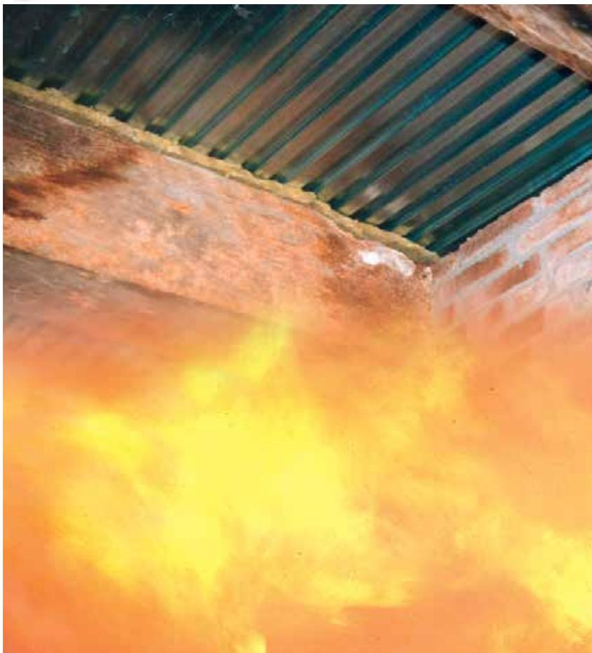
Le comportement au feu dépend de l'adjonction de protections rapportées qui empêchent la carbonisation des solives en bois, l'échauffement des solives métalliques et celui du plancher LEWIS®. Par exemple, les plafonds doivent faire l'objet d'un procès-verbal de classement délivré par un laboratoire agréé, précisant que la température atteinte
